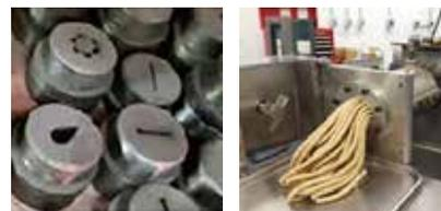
Tous les ingrédients sont mélangés en une **pâte**, chauffée (100 - 200 °C) et poussée dans de petits orifices de formes diverses, c'est la **cuisson-extrusion** (cf. photos) <sup>(1)</sup>. Les longs filaments obtenus sont mis en forme, pour certains enrobés et/ou enrichis en micronutriments thermosensibles, puis séchés.
